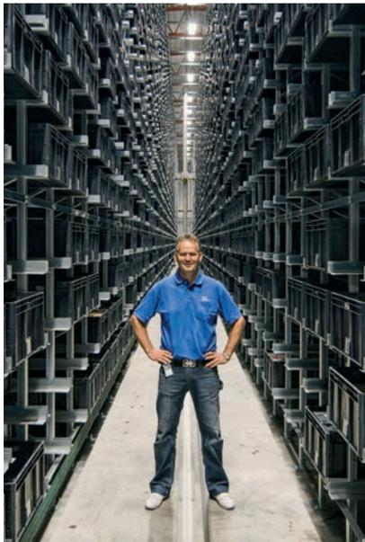
Das automatische Kleinteilelager (AKL) ist eine automatisierte Regallösung zur Lagerung und Kommissionierung von Kleinteilen. Es arbeitet nach dem Prinzip „Ware zur Person“. Verschiedenste Artikel werden in Behältern, Kartons oder auf Tablaren bei hoher Packungsdichte gelagert. Kurze Zugriffs- und Wegezeiten, direkter Zugriff auf alle Artikel sorgen für einen hohen Durchsatz und somit für eine hohe Kommissionierleistung.
