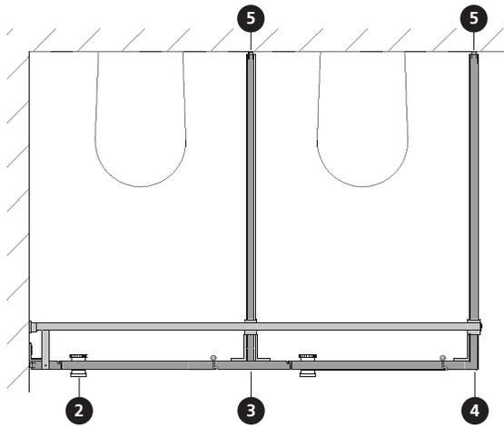
2 Schnitt Kabinenfront mit Einhandbeschlag und Steigebändern aus Aluminium
