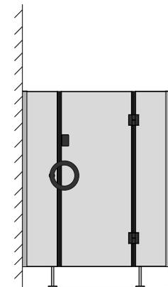
Bei Bedarf kann eine Verriegelung der Türen eingebaut werden. Diese ist so angeordnet, dass Erzieherinnen und Erzieher über die Tür greifen können, um diese im Notfall zu entriegeln.
