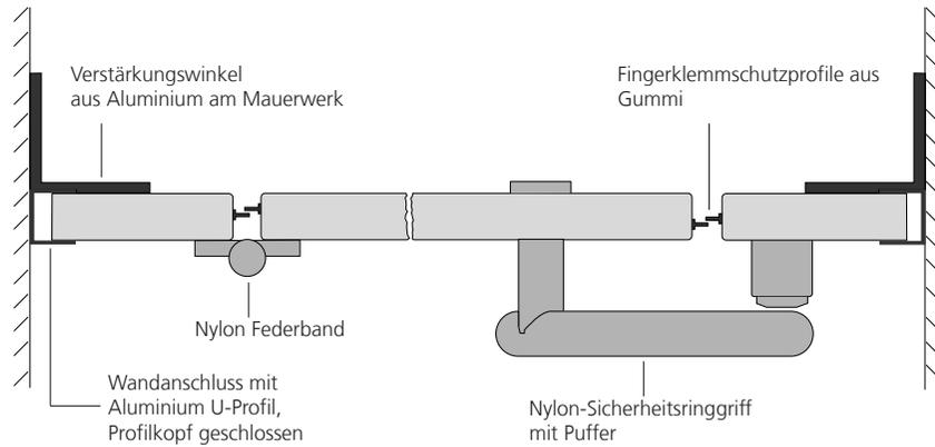
Stabilisierungslösung bei breiten Fronten
