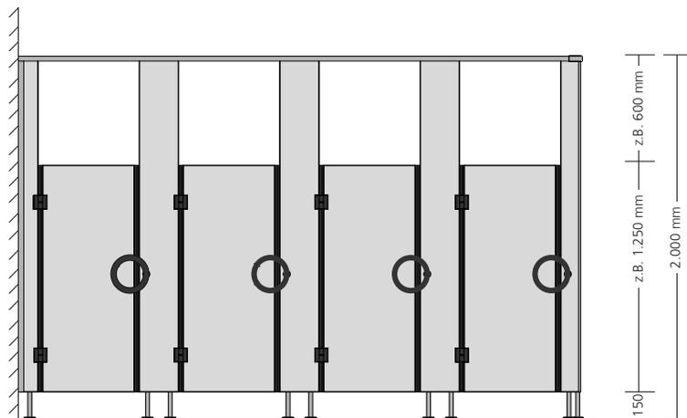
Kindergartenanlagen haben aufgrund ihrer geringen Bauhöhe in der Regel kein stabilisierendes Kopfprofil. Eine bewährte Variante ist daher die Ausführung der Frontteile in 2.000 mm Bauhöhe, so dass zur Stabilisierung ein Kopfprofil über der Front geführt werden kann.
